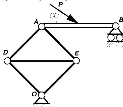
*Комментарий.* Решение, вроде бы, очевидно. Объект равновесия – балка  $AB$ , на которую действуют реакции  $S_1$  и  $S_2$  стержней  $AD$  и  $AE$ , реакция  $R_B$  шарнирно-подвижной опоры и сила  $P$ . Записав условия равновесия для балки  $AB$  получим выражение для силы  $S_1$ . Затем рассмотрим равновесие узла  $D$  и найдем силу  $S_{DE}$ . Сила минимальна, если производная равна нулю.
