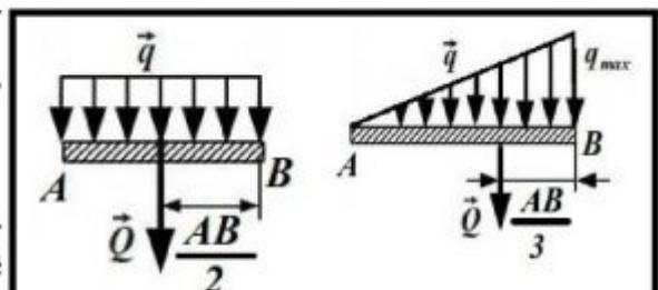
**Пример 4.** Пусть на отрезке  $AB$  действует сила, распределенная по линейному закону от  $q=0$  до  $q=q_{max}$ . Тогда её равнодействующая сила  $\vec{Q}$  будет проходить через центр тяжести прямоугольного треугольника, то есть на расстоянии  $l=\frac{AB}{3}$  от точки с максимальной нагрузкой и равна  $Q=0,5 \cdot AB \cdot q$  (Рисунок 4).
