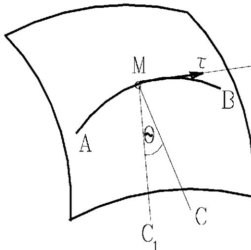
Таким образом определяются оси так называемого естественного трехгранника — касательная ось  $M\tau$  (или просто ось  $\tau$ ), главная нормаль  $n = MC$  и бинормаль  $Mb$ . В этих осях уравнения основного закона динамики имеют вид:
