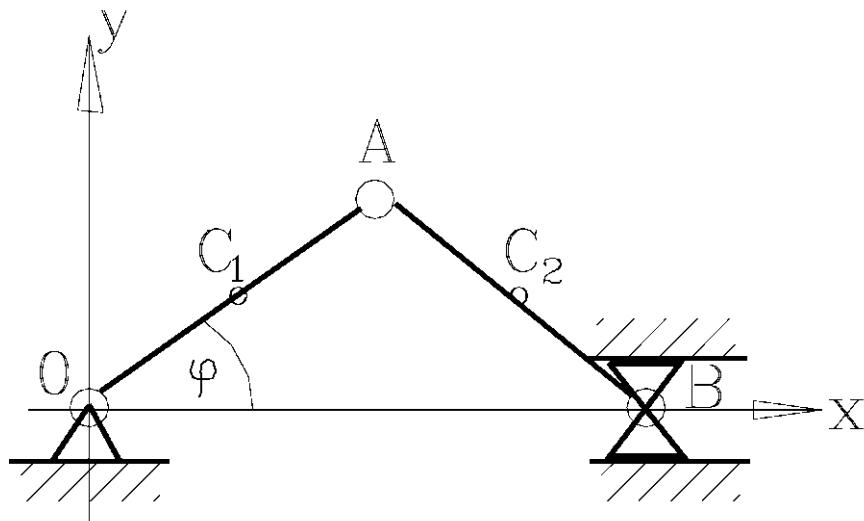
вращается с постоянной угловой скоростью  $\omega$ . Кривошип и шатун считать тонкими однородными стержнями.
