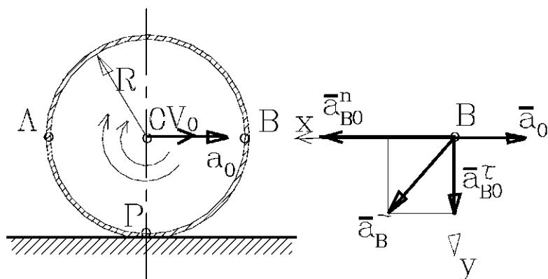
жении). Когда дифференцируем (2.47) по времени, учитываем, что движение колеса прямолинейное — иначе, когда траектория полюса кривая линия, после дифференцирования получим только касательную составляющую ускорения, а не его полное значение.
