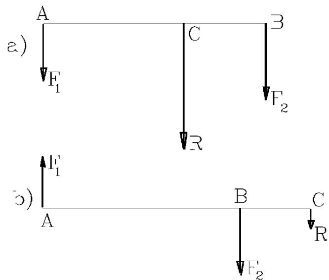
ее действия делит внешним образом расстояние между линиями действия исходных сил на части, обратно пропорциональные этим силам.
