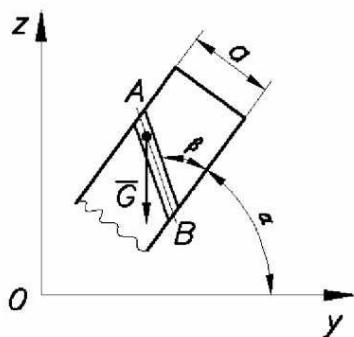
**3 (РСФСР, 1988, 7 баллов).** Шарик скатывается по  $V$ -образному жёлобу ( $\beta = 90^\circ$ ). Может ли угол  $\alpha$  наклона жёлоба к горизонту, при котором начнётся скольжение шарика, быть меньше, чем у плоской ( $\beta = 90^\circ$ ), опоры? Коэффициент трения скольжения  $f$  не зависит от величины угла  $\beta$ . Для шарика  $J_{cz} = 0,4 \text{ m}^2$ .
