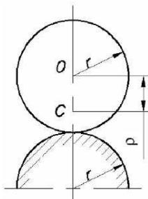
**7 (РСФСР, 1986, 7 баллов).** Цилиндр со смещённым с оси центром тяжести опирается на негладкую цилиндрическую поверхность таким же, как у цилиндра, радиусом  $r$ . Коэффициент сцепления (трения покоя) равен  $f$ .
