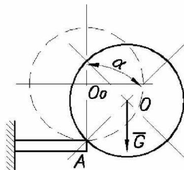
**15 (РСФСР, 1987, 5 баллов).** Однородный диск радиусом  $r$  и весом  $G$ , вращающийся с угловой скоростью  $\omega_0$ , медленно опустили (без толчка) на горизонтальную шероховатую плоскость и в момент касания освободили. Определить работу сил трения за время проскальзывания диска по плоскости. Коэффициент трения скольжения  $f$ , трение качения мало.
