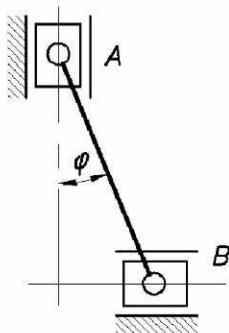
**20 (БССР, 1985, 4 балла).** Механизм расположен в горизонтальной плоскости;  $OA$  и  $AB$  – невесомые стержни длиной  $l$ , ползун имеет массу  $m$ . Механизм движется под действием момента  $M$ , приложенного к кривошипу  $OA$ , при этом угловая скорость  $\omega$  кривошипа постоянна. Определить момент  $M$ . Трение не учитывать.
