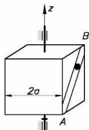
**13 (М., 1977, 5 баллов).** Определить угловую скорость куба в момент, когда частица массой  $m$ , помещённая в ёлобе на диагонали  $AB$  грани куба, достигнет точки  $A$ . В начальный момент частица была в точке  $B$ , а вся система находилась в покое. Момент инерции куба относительно центральной оси  $z$  (вертикальной) равен  $J = 8ma^2$ . Силы трения не учитывать.
