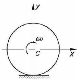
**12 (РСФСР, 1984, 5 баллов).** Однородный диск радиусом  $R$  и весом  $P$  катится без скольжения в вертикальной плоскости по горизонтальному рельсу из состояния покоя. К диску прикреплена материальная точка  $M$  весом  $P$ . Начальное положение системы показано на рисунке. Определить наибольшее давление на рельс и соответствующую силу сцепления. Сопротивление качению не учитывать.
