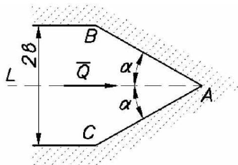
**2 (РСФСР, 1983, 5 баллов).** В доске, установленной в вертикальной плоскости под углом  $\alpha$  к горизонту, необходимо просверлить наклонное отверстие, так, чтобы материальная точка, опущенная в отверстие в точке  $A$  без начальной скорости, прошла сквозь доску под действием силы тяжести в кратчайшее время. Коэффициент трения равен  $f$ . Определить угол  $\beta$  наклона отверстия.
