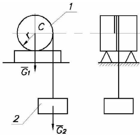
**11 (РСФСР, 1990, 7 баллов).** Определить ускорения тел плоской механической системы, движущейся под действием сил тяжести. Ось  $OZ$  вертикальна. Массы тел:  $m_1 = m$ ,  $m_2 = 0,5m$ ; угол  $\alpha = 30^\circ$ . Трение отсутствует.
