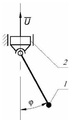
**5 (РСФСР, 1985, 5 баллов).** Тяжёлый грузик 1 прикреплён к телу 2 при помощи идеального шарового шарнира и невесомого стержня длиной  $l$ . Движение происходит на горизонтальной негладкой плоскости (коэффициент трения скольжения между грузиком и плоскостью равен  $f$ ). Стержень не касается плоскости, а тело имеет постоянную скорость  $U$ . Определить период малых колебаний грузика. При каких значениях  $U$  возможны периодические колебания?
