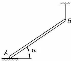
**4 (СССР, 1986, 7 баллов).** Однородный стержень в состоянии покоя опирается концом  $A$  на гладкий пол. Конец  $B$  удерживается вертикальной нитью. Стержень составляет угол  $\alpha$  с горизонтальным полом, его масса равна  $m$ , длина  $l$ .
