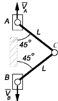
*Пример 5.* Определить скорость и ускорение точки  $C$  плоского механизма в положении, указанном на рисунке, если известны скорости  $V_A$  и  $V_B$ , а ускорения точек  $A$  и  $B$  равны нулю.
