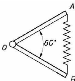
**5 (СССР, 1988, 7 баллов).** Два одинаковых однородных стержня  $OA$  и  $OB$  массой  $m$  каждый соединены шарнирно в точке  $O$  и расположены на гладкой горизонтальной плоскости под углом  $60^\circ$  друг к другу. Затем концы стержней  $A$  и  $B$  соединили сжатой пружиной  $AB$  ( $OA = OB = l$ , длина ненапряжённой пружины равна  $1,1l$ ). Определите максимальное перемещение  $S_{\max}$  шарнира  $O$  в процессе движения системы, если в начальный момент стержни покоялись.
