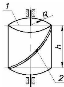
**2 (СССР, 1982, 6 баллов).** Две пластины с желобами, по которым может скользить грузик (материальная точка), изготовлены из листовых квадратных заготовок. Материал и толщина листа одинаковы. В начальный момент обе пластины вращаются с угловой скоростью  $\omega_0$ , а грузики одинаковой массы находятся в желобах в наивысших точках.
