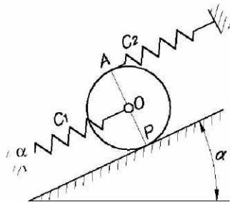
**10 (Л., 1983, 6 баллов).** Тяжёлый цилиндр массой  $m$  и радиусом  $r$  лежит на вогнутой поверхности, имеющей радиус кривизны  $R$ . К верхней точке цилиндра прикреплены пружины-растяжки жёсткостью  $C$  каждая. Составить дифференциальное уравнение малых колебаний цилиндра, считая, что он катится по опорной поверхности без скольжения. Определить период собственных колебаний цилиндра в случае, когда опорная поверхность является горизонтальной плоскостью.
