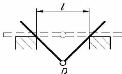
**26 (Ленинградский кораблестроительный ин-т, 1977, 6 баллов).** Доска  $1$  весом  $Q_1$  движется по негладкой горизонтальной плоскости под действием горизонтальной силы  $P$ . Коэффициент трения между доской и плоскостью равен  $f$ . На доске лежит однородный сплошной круглый цилиндр  $2$  весом  $Q_2$ , который может катиться по доске без скольжения. Определить ускорение доски.
