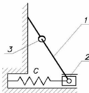
**3 (СССР, 1982, 6 баллов).** Тяжёлая рамка 1, момент инерции которой относительно вертикальной оси  $Oz$  равен  $J$ , движется под действием пары сил с моментом  $M$ . Концы однородного тяжёлого стержня 2 длиной  $l$  и массой  $m$  скользят без трения по сторонам рамки. Составить дифференциальные уравнения движения данной механической системы в обобщённых координатах  $\phi_1$  и  $\phi_2$ . Трением пренебречь.
