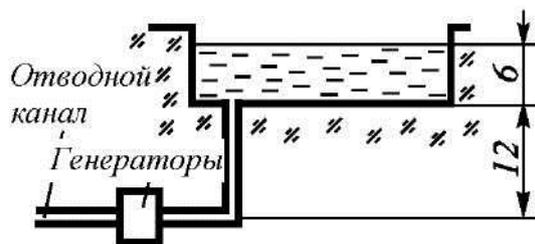
4. Водохранилище при гидроэлектростанции имеет площадь  $2 \text{ км}^2$  и глубину  $6$  м. Дно водохранилища лежит на высоте  $12$  м выше уровня воды в отводном канале за гидроэлектростанцией. Определить работу, которую может совершить сила тяжести запасённой в водохранилище воды.
