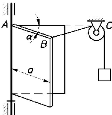
**Д10.4** (Омск. политех. ин-т, 1985). Дверь закрывается при помощи верёвки с гирей на конце, переброшенной через лёгкий блок. Вес двери  $Q$ , вес гири  $P$ ,  $AB = AC = a$ . В начальный момент дверь была открыта на угол  $\alpha = 60^\circ$  и находилась в покое. Определить угловую скорость двери в момент закрытия. Трение не учитывать.
