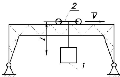
**Д10.12** (Омск. политех. ин-т, 1984). Груз 1 перемещается вместе с тележкой 2 по горизонтальной ферме мостового крана со скоростью  $V$ . Расстояние от центра тяжести груза до точки привеса равно  $l$ . При внезапной остановке тележки груз по инерции будет продолжать движение и начнет качаться около точки привеса. Определить наибольшее натяжение троса и наибольшую высоту подъема груза.
