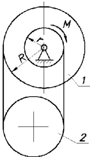
Д3.7 (Свердловск, 1986). Механическая система состоит из ступенчатого барабана 1, однородного диска 2 и гибкой нерастяжимой нити.
