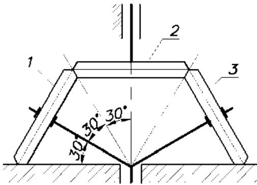
**Д10.10** (Гольягтинск. политех. ин-т, 1986). Фрикционный механизм состоит из трёх одинаковых роликов (дисков) массой  $m$  и радиусом  $r$ . Ролики 1 и 3 меняются местами каждую секунду. Определить суммарную кинетическую энергию роликов.
