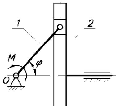
Д3.23 (Омск. политех. ин-т, 1988). К кривошипу  $1$  механизма, расположенного в горизонтальной плоскости, приложен постоянный момент  $M$ , при движении кулисы  $2$  возникает постоянная по величине сила сопротивления  $F$ . Движение начинается из состояния покоя в положении, когда  $\varphi = 0$ . Кривошип – однородный стержень длиной  $l$ , известны массы кривошипа и кулисы.
