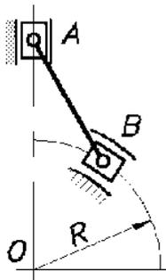
**Д2.31** (Тамб. ин-т хим. машиностр., 1985). В механизме, расположенном в вертикальной плоскости, однородный стержень  $AB$  длиной  $l$  и массой  $M$  имеет на концах ползуны, один из которых скользит по вертикальной направляющей, а другой по дуге окружности радиусом  $R = l$  с центром в точке  $O$ , лежащей на одной вертикали с ползуном  $A$ . Стержень
