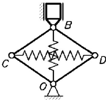
**Д3.28** (УСССР, 1987). Ползун массой  $M$ , движущийся в вертикальном направлении в направляющих, связан с ромбом, образованным стержнями длиной  $l$  и массой  $m$ . Пружина с коэффициентом жёсткости  $c_1$  связывает вершины  $C$  и  $D$ , пружина с жёсткостью  $c_2$  связывает вершины  $O$  и  $B$ . В положении равновесия углы между стержнями составляют  $90^\circ$ .
