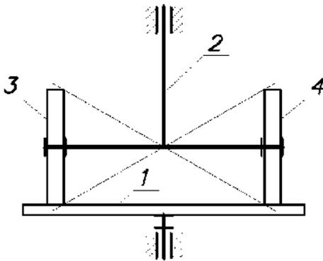
Д2.7 (Поволжск. зона, 1986). Во frictionном механизме диск 1 за каждую секунду совершает 1 оборот, а водило 2 вращается вдвое медленнее. Определить кинетическую энергию ролика 3 (или 4), считая ролик диском массой  $m$  и радиусом  $r$ . Скольжением пренебречь.
