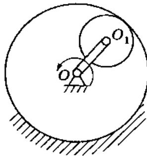
Определить время  $\tau$  торможения и угол  $\varphi$  поворота кривошипа за это время, если его масса равна  $M_1$ ,  $M_2$  — масса сателлита,  $R$  и  $r$  — радиусы большого и малого колес. Кривошип принять за однородный тонкий стержень, сателлит — за однородный диск.
