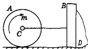
Определить зависимость между путем  $s$ , пройденным щитом  $B$  снегоочистителя, и модулем его скорости  $v$ , если в начальный момент система находилась в покое.
