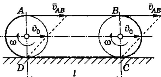
Часть гусеницы  $BC$  длиной  $\pi r$  и массой  $\gamma \pi r$  совершает плоскопараллельное движение. Ее кинетическая энергия
