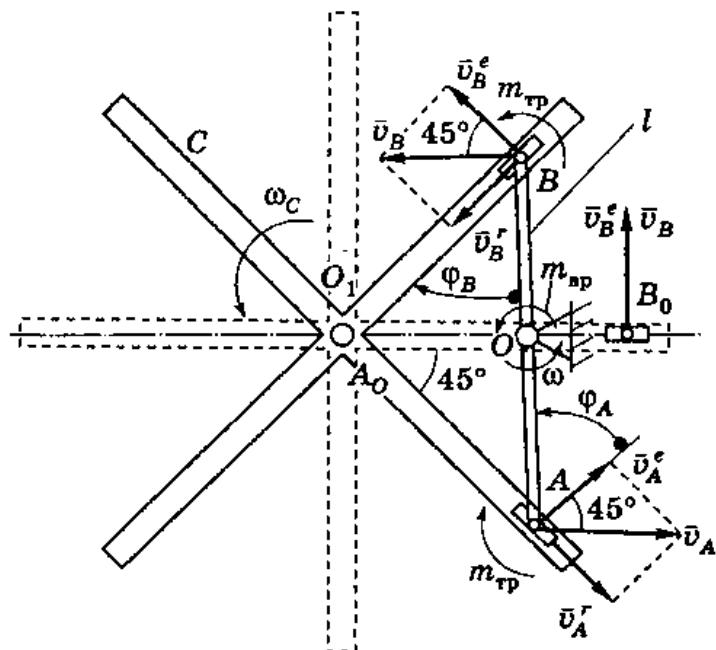
Найдем угловую скорость крестовины в конечном положении. Ползуны  $A$  и  $B$  совершают сложное движение: абсолютное вместе со стержнем  $AB$ , переносное — вращательное вместе с крестовиной, относительное — вдоль прорезей крестовины.
