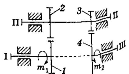
литъ угловое ускорение шпинделя III, если моменты инерции всех вращающихся деталей, насаженных на валы I, II и III, соответственно равны  $I_1$ ,  $I_{II}$ ,  $I_{III}$ . Радиусы равны  $r_1$ ,  $r_2$ ,  $r_3$  и  $r_4$ .
