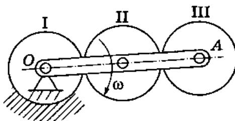
Вычислить кинетическую энергию механизма, считая колеса однородными дисками, а кривошип — однородным стержнем. Чему равна работа пары сил, приложенной к колесу III?
