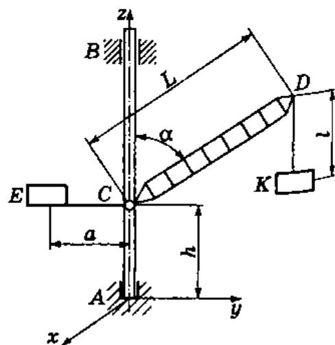
осей координат  $x$ ,  $y$ ,  $z$ , связанных с краном. Центр масс всей системы находится на оси  $z$ ; стрела  $CD$  расположена в плоскости  $yz$ .
