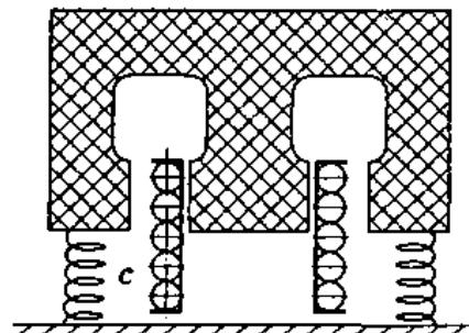
циональная его скорости, вызываемая демпфером, создающим силу сопротивления  $\bar{F}$ . Составить уравнения, определяющие перемещение сердечника и ток в цепи в случае малых вертикальных колебаний основания сейсмометра по закону  $\xi = \xi_0 \sin \omega t$ .
