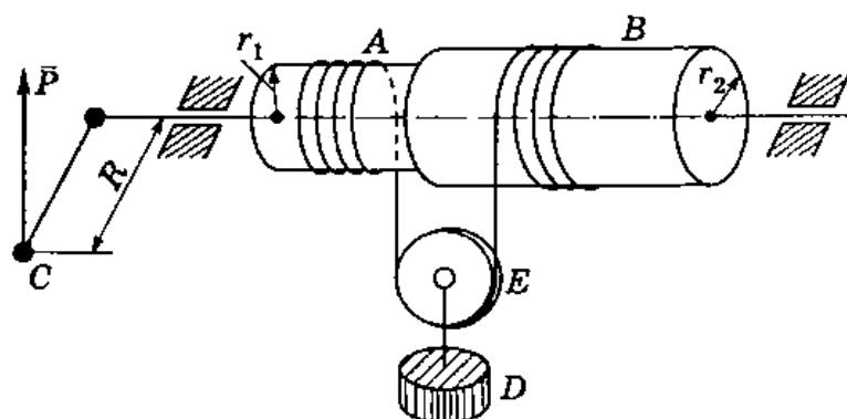
При вращении рукоятки  $C$  левая ветвь каната сматывается с вала  $A$  радиуса  $r_1$ , а правая ветвь наматывается на вал  $B$  радиуса  $r_2$  ( $r_2 > r_1$ ). Какую силу  $\bar{P}$  надо приложить перпендикулярно рукоятке в конце ее для того, чтобы уравновесить груз  $D$ , если  $M = 720$  кг,  $r_1 = 10$  см,  $r_2 = 12$  см,  $R = 60$  см?
