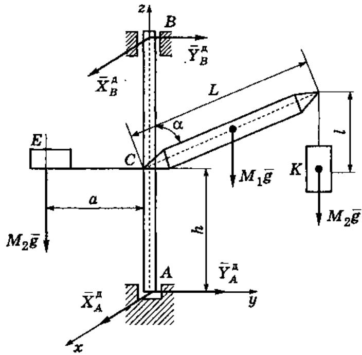
Поскольку согласно условию центр масс крана находится на оси  $AB$ , то  $x_C = y_C = 0$ . Динамические реакции необходимо определить в конце торможения крана, поэтому  $\omega \approx 0$ . Найдем угловое замедление крана при торможении:
