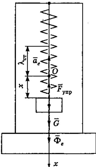
Составим дифференциальное уравнение относительного движения груза датчика в проекции на ось  $x$ :
