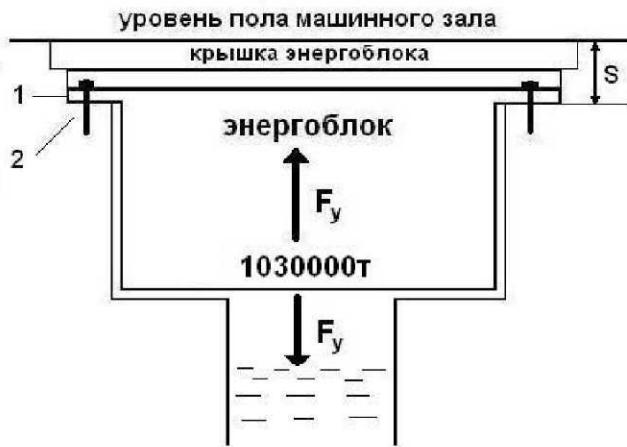
Рис. 19. Схема к определению времени действия ударной силы на энергоблок
