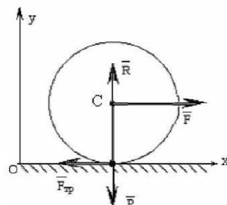
**Решение.** К колесу приложены внешние силы:  $P$  – его вес,  $F$  – движущая сила,  $R$  – нормальная реакция рельса,  $F_{tp}$  – сила трения скольжения, направленная вдоль рельса в сторону, противоположную силе  $F$ .
