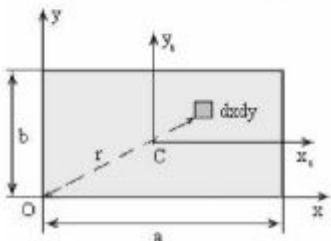
Самостоятельно вычислите  $J_{x_1}, J_{y_1}, J_c$  моменты инерции относительно осей проходящих через центр масс, и полярный момент инерции относительно центра  $C$ .
