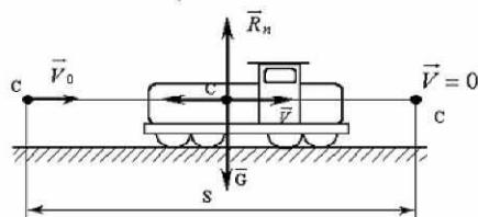
**Решение.** 1. Для определения тормозного пути  $S$  применим теорему об изменении кинетической энергии  $T_1 - T_0 = \sum A_{10}(\bar{F})$ . В данном случае  $V_1=0$ ,  $A(\bar{F}_{mp}) = FS \cos(\alpha) = -FS = -0,12GS$  (угол  $\alpha$  между направлением силы  $\bar{F}$  и направлением перемещения равен  $180^\circ$ ), а работы сил  $\bar{G}$  и  $\bar{R}_n$  равны нулю (эти силы действуют перпендикулярно к направлению перемещения), поэтому  $-\frac{mV_0^2}{2} = -Fs$ .
