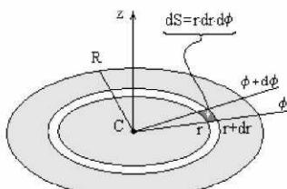
**Задача 4.** Вычислить моменты инерции относительно осей координат  $x, y, z$  тонкой однородной круговой пластины радиуса  $r$ , внутри которой вырезан квадрат со стороной  $a$ , центры квадрата и круга совпадают.  $M$  — масса пластины с вырезом.
